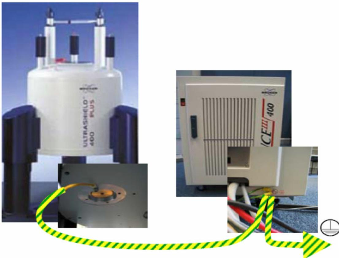
Figure 3.1: Spectromètre AVANCE avec préamp interne
