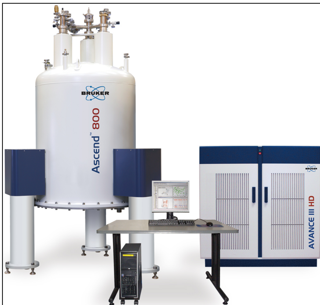
Figura 4.1: Magnete, console dell'operatore e console
