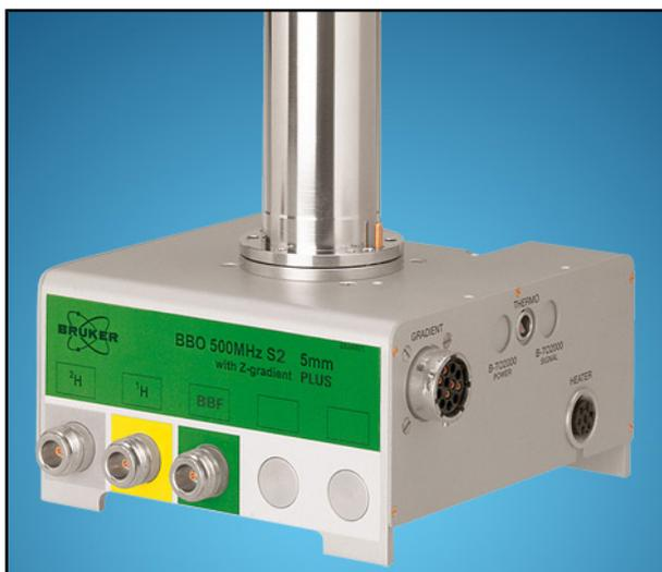
Figure 4.7: Exemple de sonde large bande
