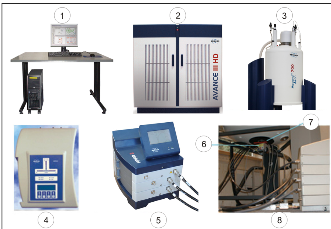
Abbildung 4.3: Magnet, Shimming-System, Probenkopf und HPPR
