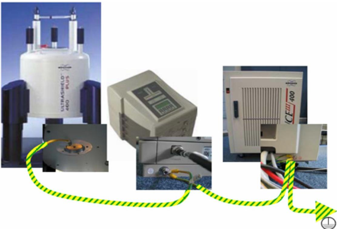
Abbildung 3.2: AVANCE Spektrometer mit externem Vorverstärker (HPPR/2)
