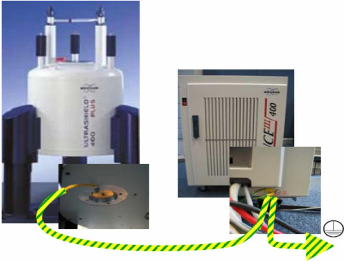
Abbildung 3.1: AVANCE Spektrometer mit internem Vorverstärker
