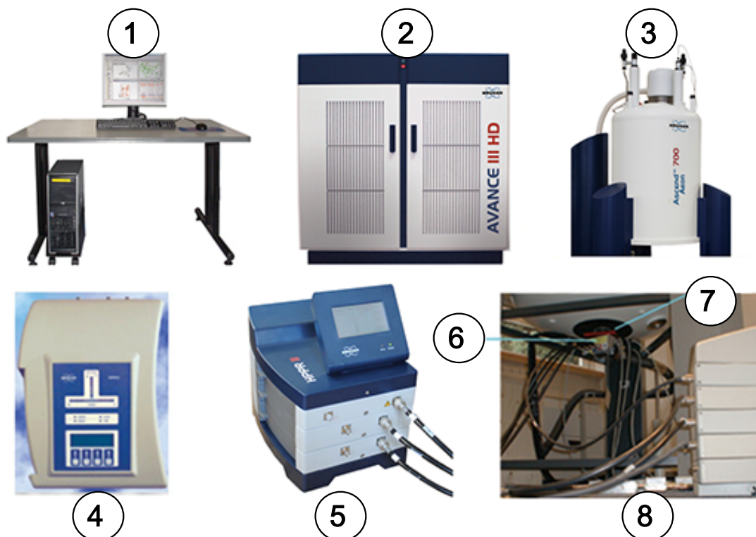
Figura 4.3: Fotografia do Íman, Sistema de homogeneização, Sonda e HPPR
