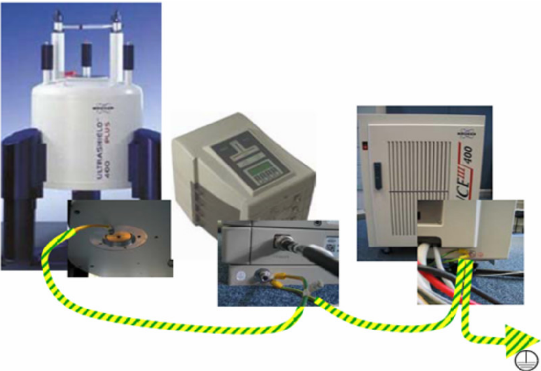
图 3.2: 带外部前置放大器的 AVANCE 波谱仪 (HPPR/2)
