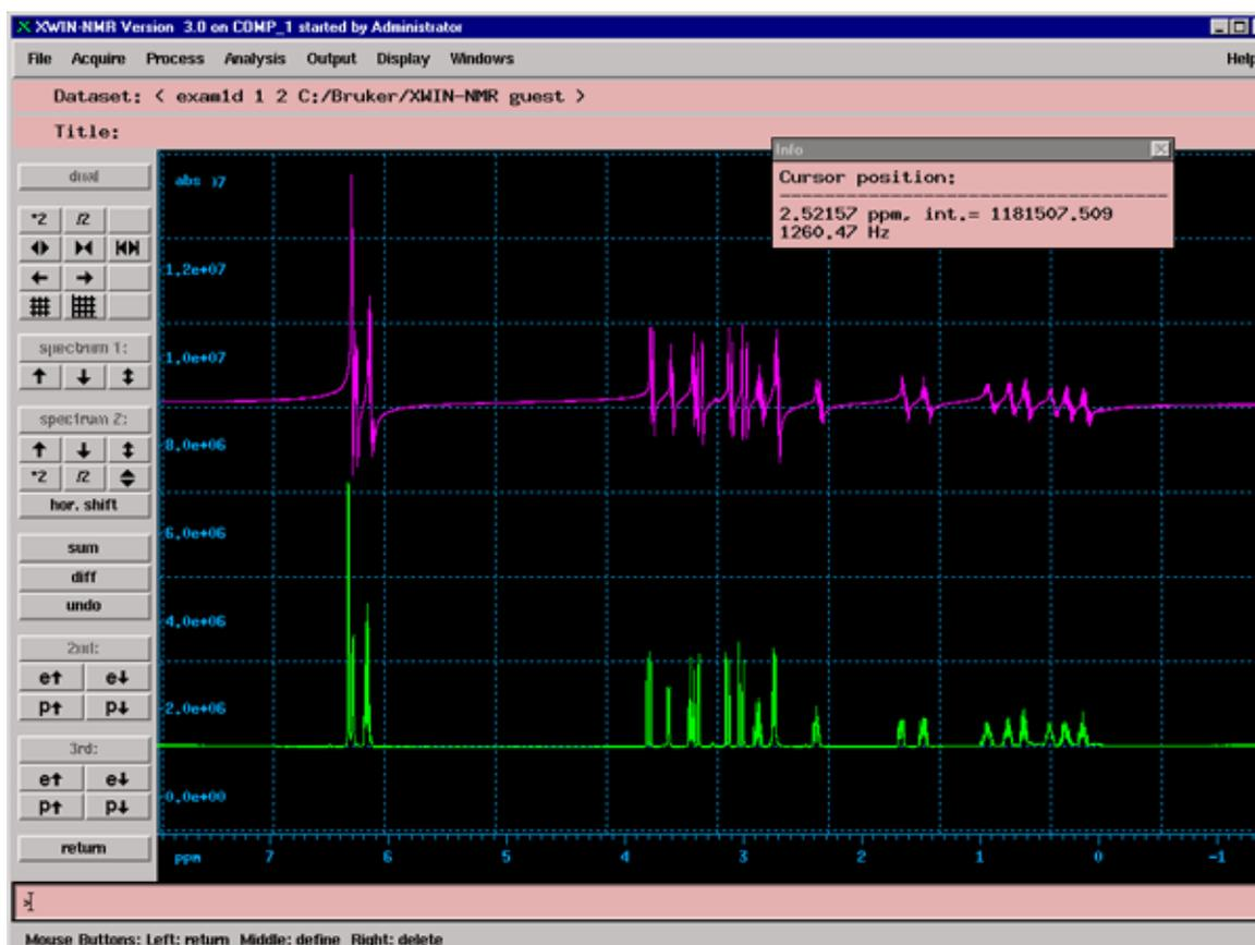
El usuario necesita entender la diferencia entre correcciones de fase de orden cero y de primer orden. Los valores numéricos de estas dos correcciones se guardan utilizando los parámetros phc0 y phc1, respectivamente. Los valores de estos dos parámetros pueden inspeccionarse introduciéndolos en la línea de comando o bien llamando la tabla de parámetros de procesamiento con el comando "edp"
