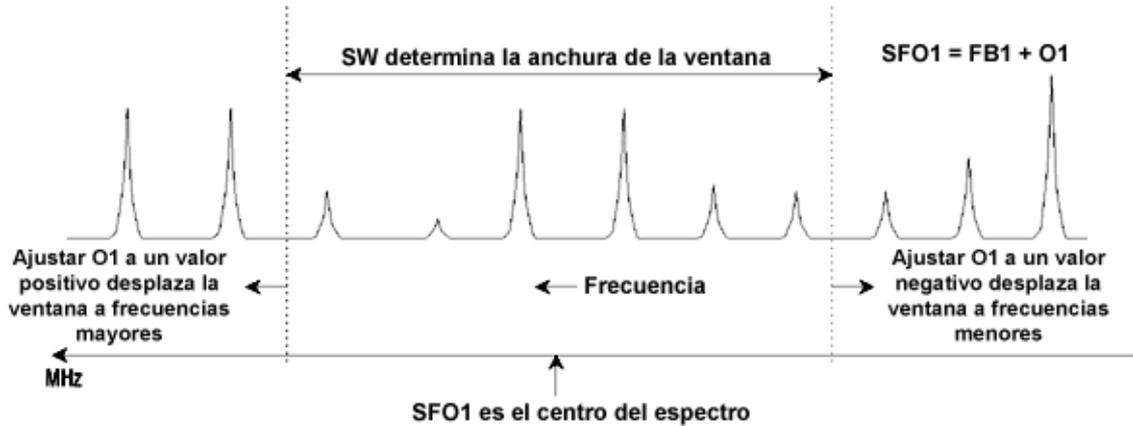
Para ayudarle a ajustar una anchura espectral (barrido) idónea, se ha incorporado al software, en el submenú de utilidades, la función especial SW-SFO1. Para más detalles **"Ajuste de la anchura espectral con la función SW-SFO1" en la página 103.**
