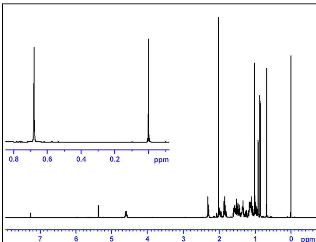
Dieciséis escanes. SW = 20.66 pm, Pico del TMS calibrado a 0 ppm.
