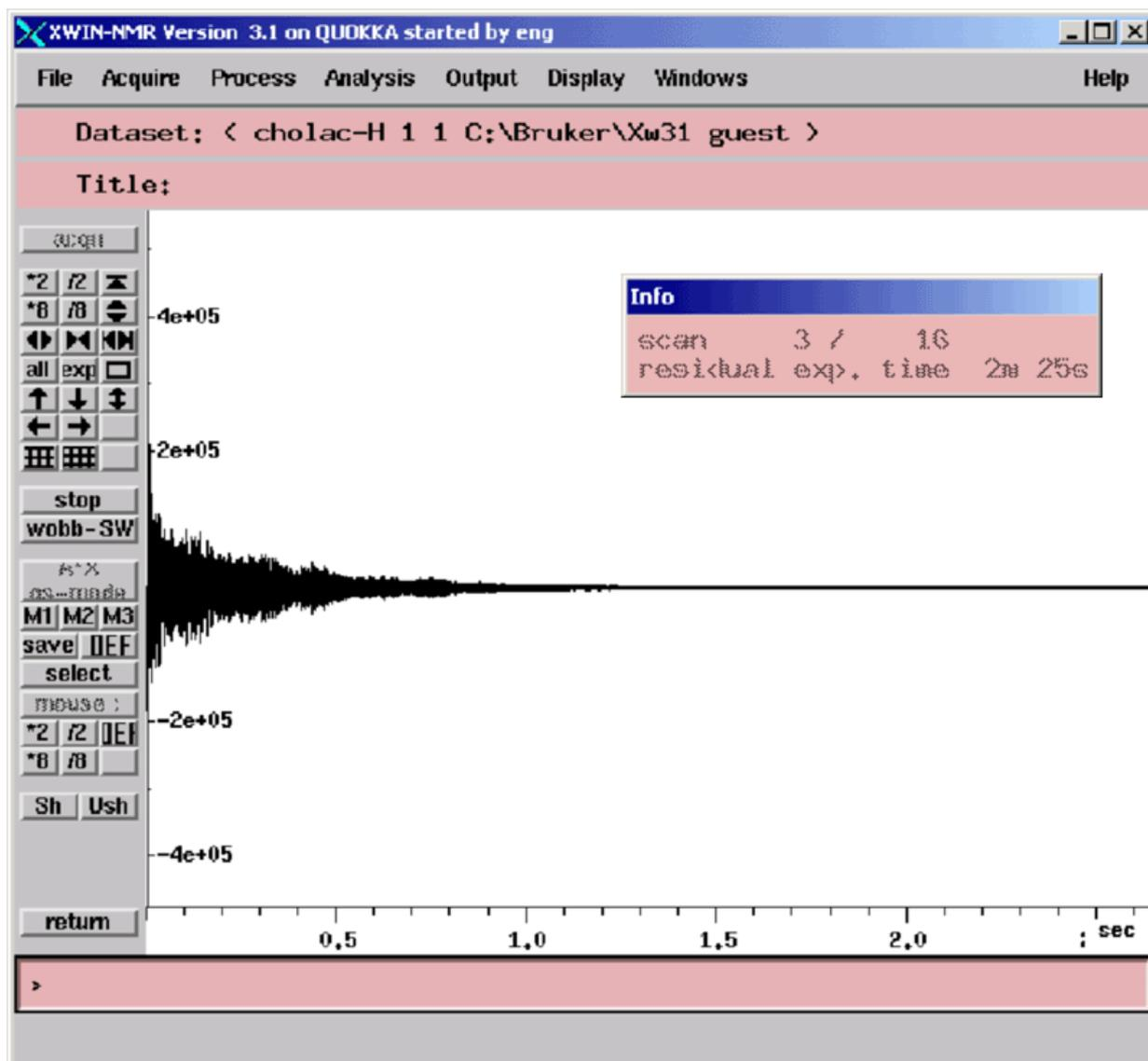
**Scan 3/16** significa que el espectrómetro ha realizado tres escanes y en este momento está realizando el cuarto de 16 escanes.
