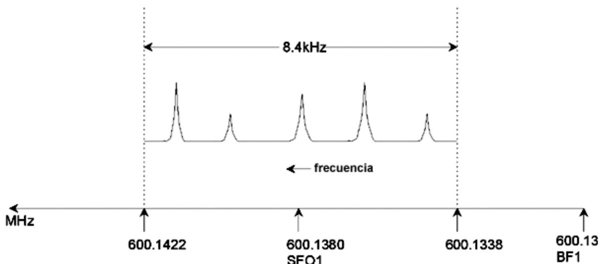
Debe observarse que el valor de SWH utilizado en cualquier experimento dado, se determina únicamente en función de la muestra a analizar y de la resolución espectral requerida. El valor de 14 ppm para los espectros de hidrógeno asegura que se detecten la mayoría de las señales.
