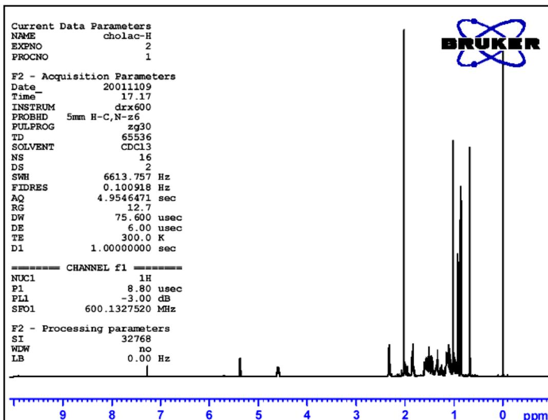
Dieciséis escanes. SW = 11pm. Pico del TMS calibrado a 0ppm.
