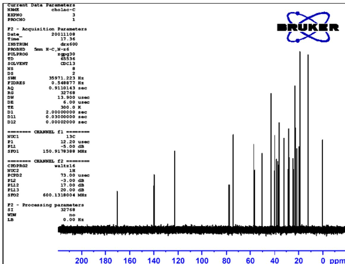
Observe también, el gran incremento de la relación señal / ruido. El efecto del desacoplamiento es tan espectacular, que raramente cualquier usuario experimentado pierde tiempo realizando un espectro de  $^{13}\text{C}$  sin desacoplamiento.
