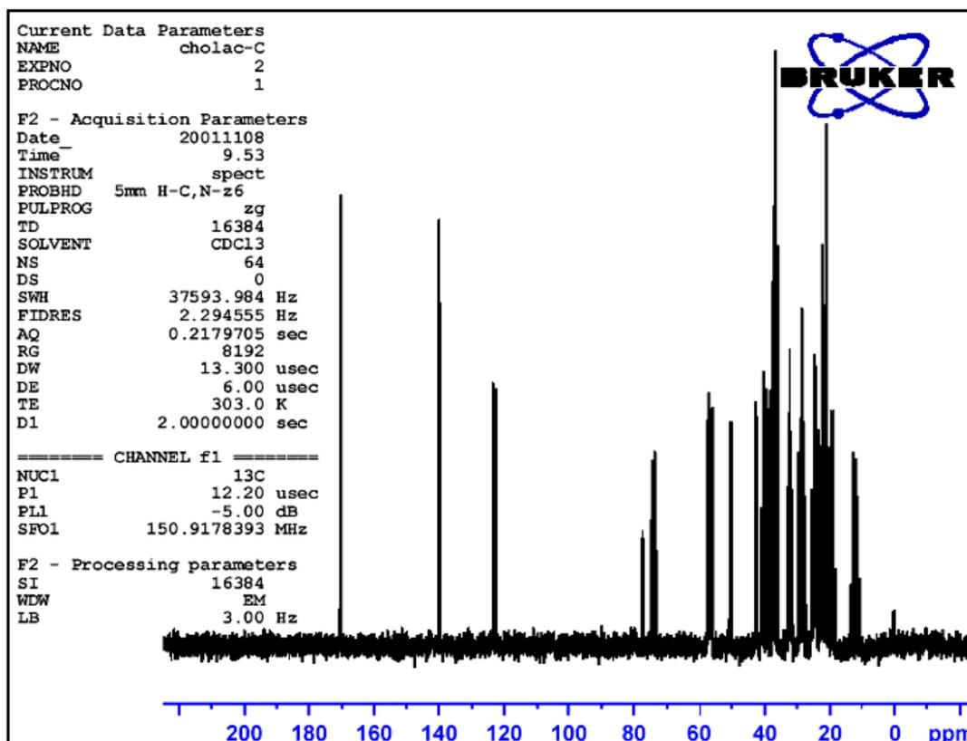
El escaneo repetido, ciertamente incrementa drásticamente el número de picos significativos, pero el espectro todavía tiene demasiado ruido. El usuario, también puede ahora optimizar SW y la frecuencia observada utilizando la función SW-SFO1 descrita en la sección **"Ajuste de la anchura espectral con la función SW-SFO1" en la página 103.**
