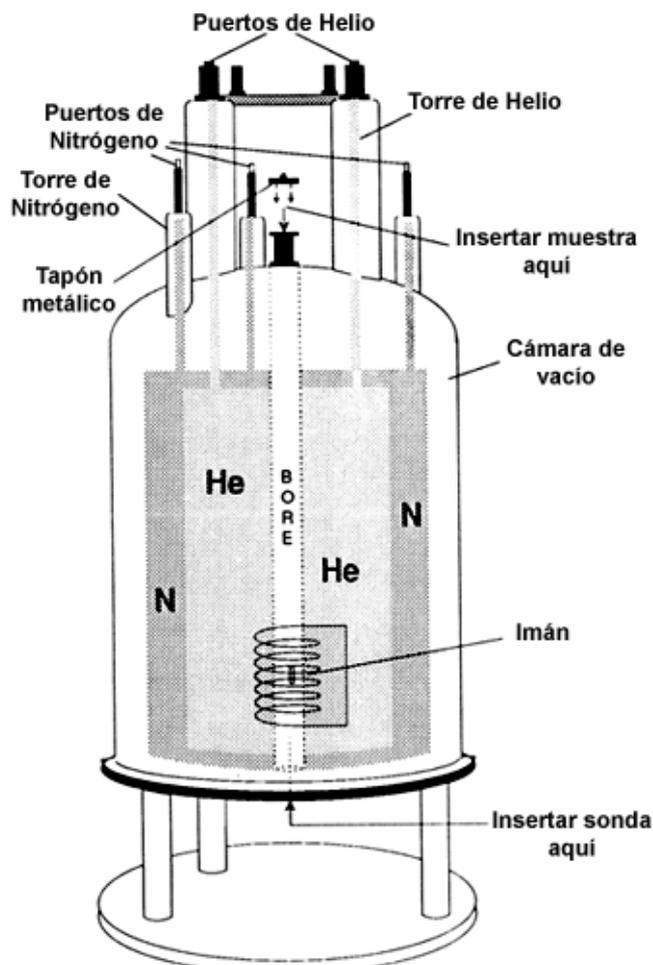
Los tres mástiles más cortos que se prolongan por encima del imán, permiten acceder al tanque de nitrógeno. Puede usarse cualquiera de los tres puertos, para comprobar el nivel de nitrógeno con una varilla idónea (¡únicamente usuarios experimentados!!!) y rellenar el nivel si es necesario. De nuevo, el responsable del sistema debe comprobar regularmente que cualquier válvula insertada en los puertos de nitrógeno no se bloquee con hielo.
