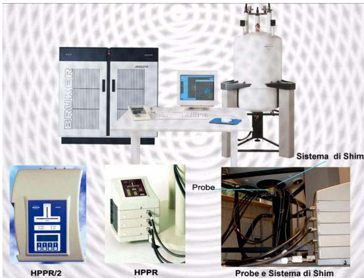
Anche se l'**HPPR** (Preamplificatore ad alte Prestazioni) trasporta il segnale trasmesso al campione, la sua funzione primaria è di amplificare il segnale, relativa-
